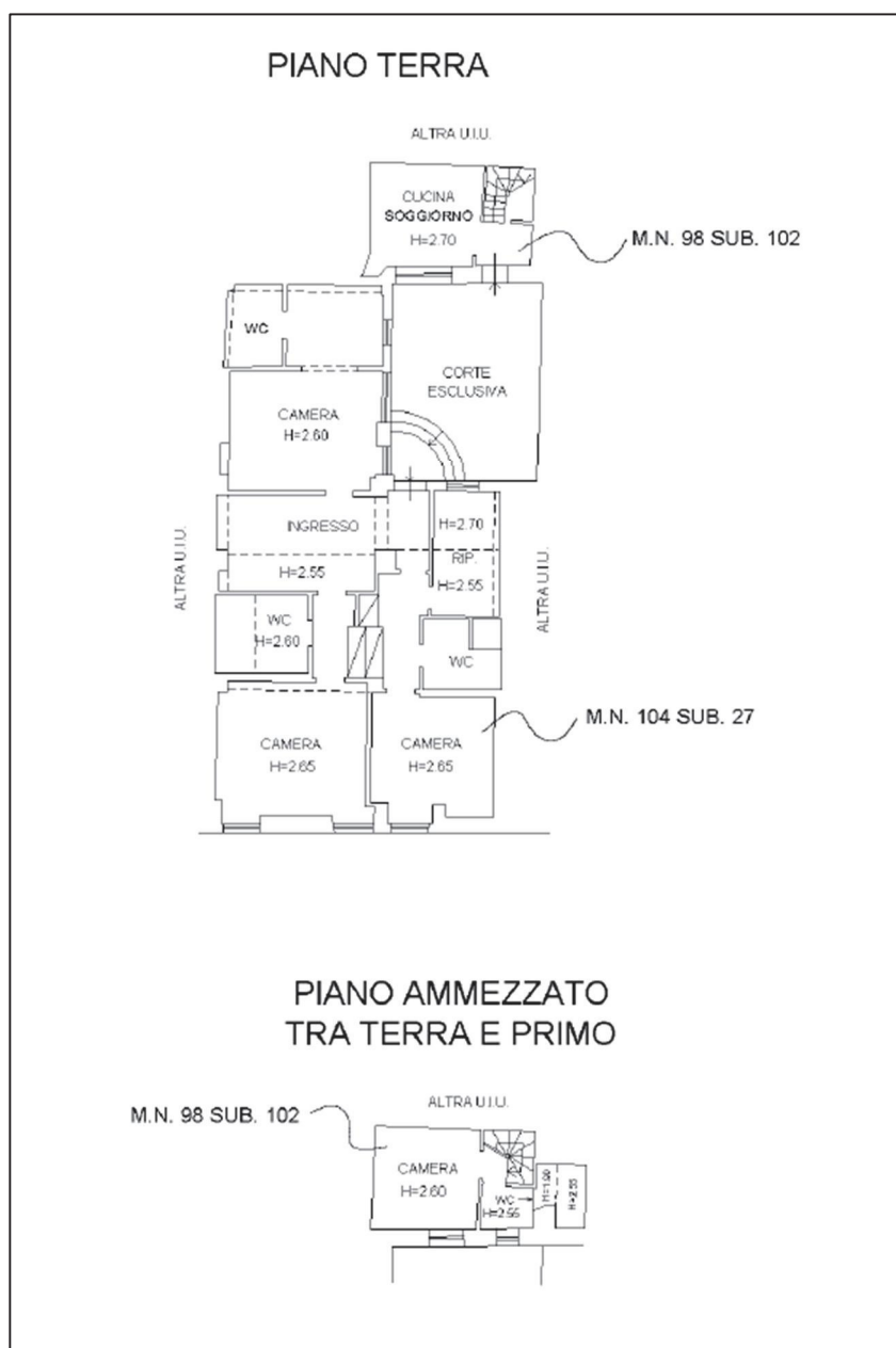
Figura 49: planimetria catastale dell'abitazione identificata con la particella 98 sub 102 (graffata alla particella 104 sub 27) redatta dallo scrivente a seguito di aggiornamento per esatta rappresentazione dei luoghi
