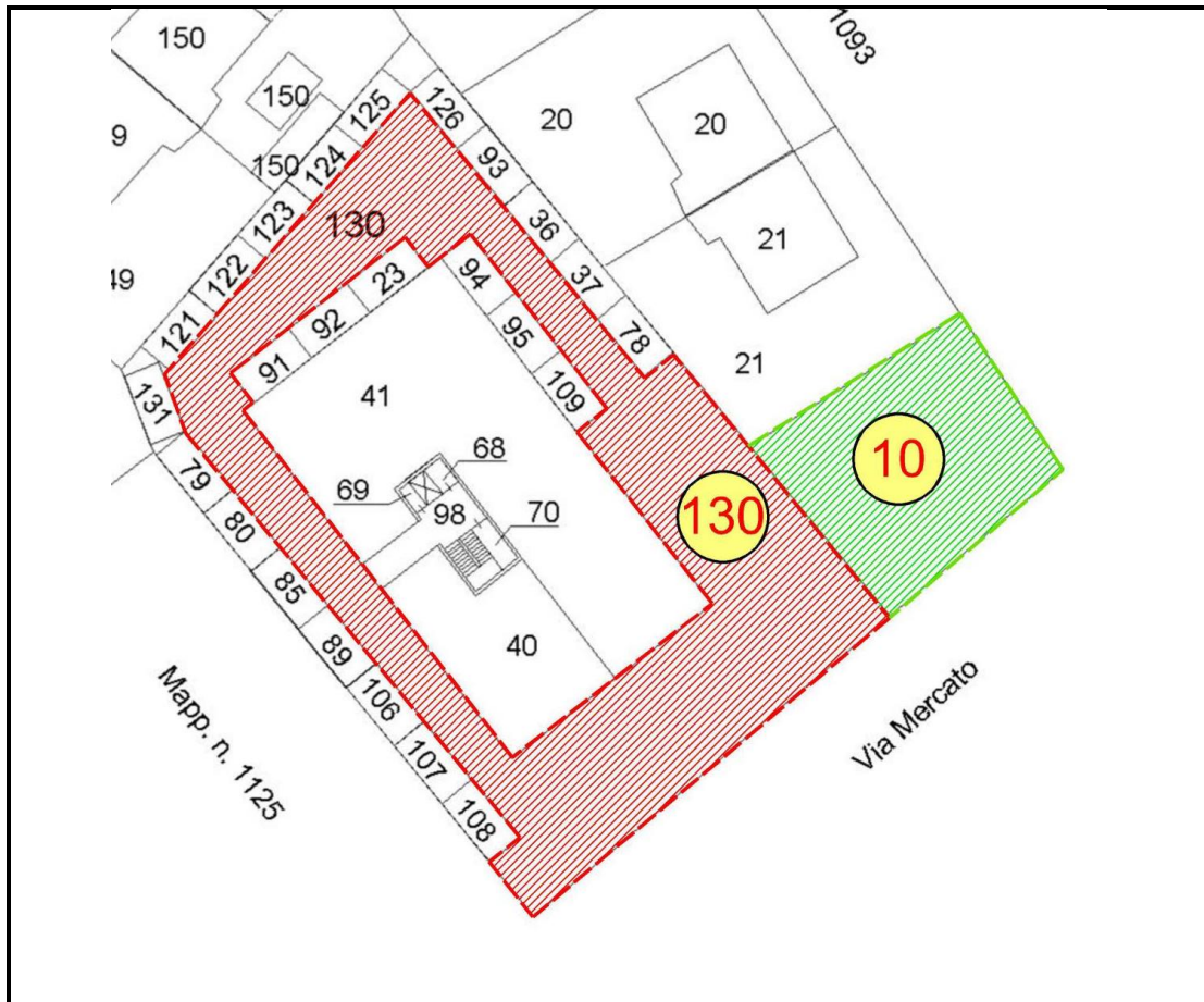
Figura 1 – Elaborato planimetrico catastale part. 1205 – sub130 (individuato dalla campitura di colore rosso) - sub 10 (individuato da campitura di colore verde).
