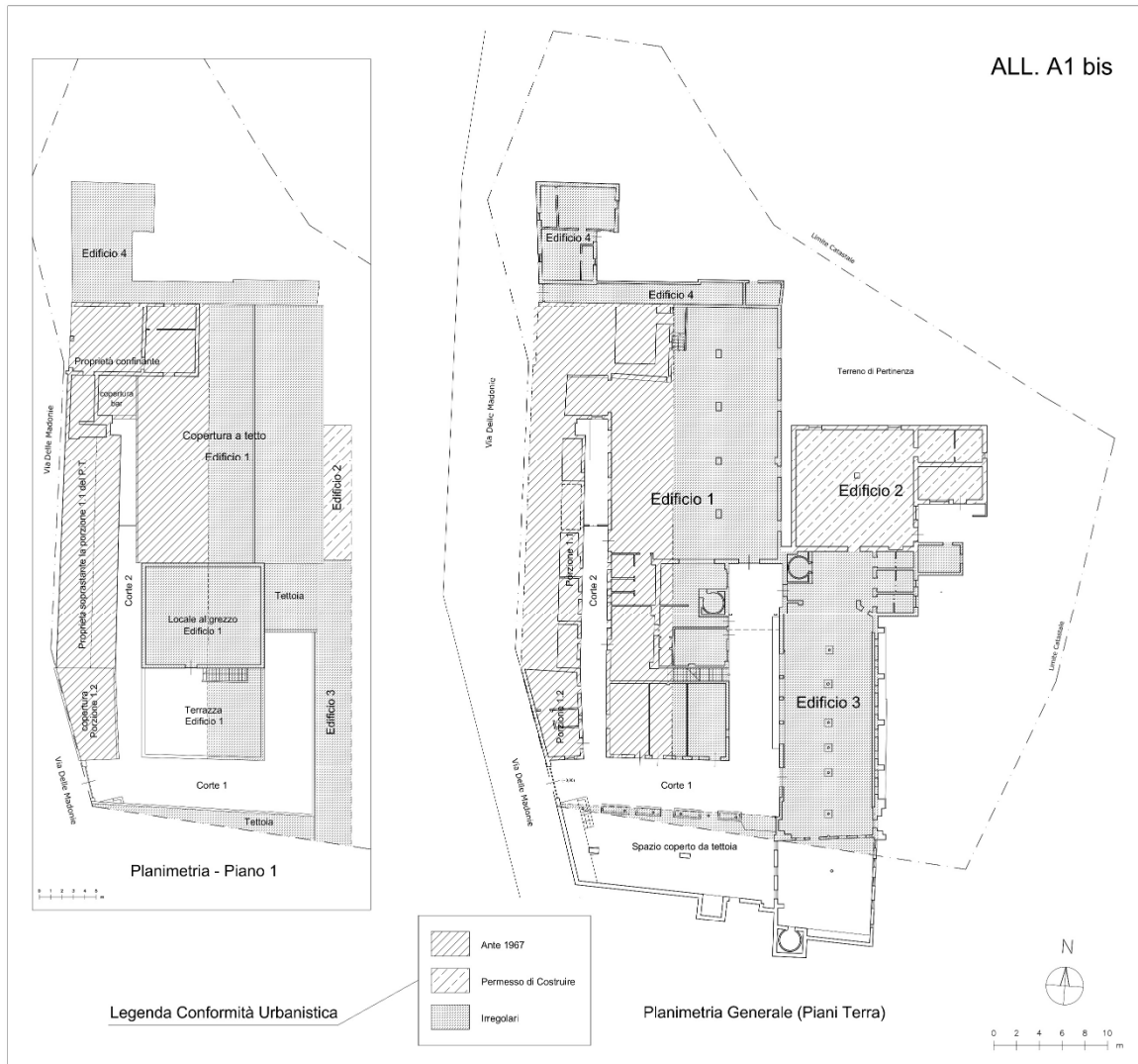
Figura 2: Planimetria dello stato dei luoghi con indicazione grafica delle difformità.
