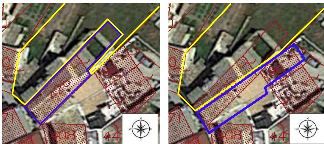
Figure 12 – A dx l'errato inserimento in mappa della 426, a dx il corretto inserimento che dovevasi effettuare
