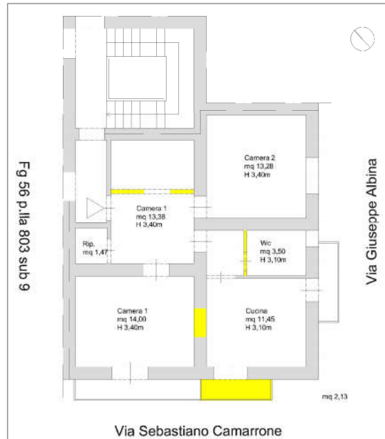
Planimetria di rilievo attuale con indicazione delle riscontrate difformità
