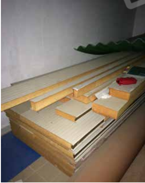
262. Ritagli di pannelli isolanti di lunghezza circa 4 m e di larghezza varia (Edificio B - 1° Piano)
