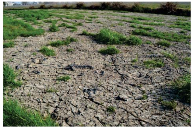
foto 8 - Particolare del m.n. 58 con evidenze d'apporto di limo argilloso con materia plastica
