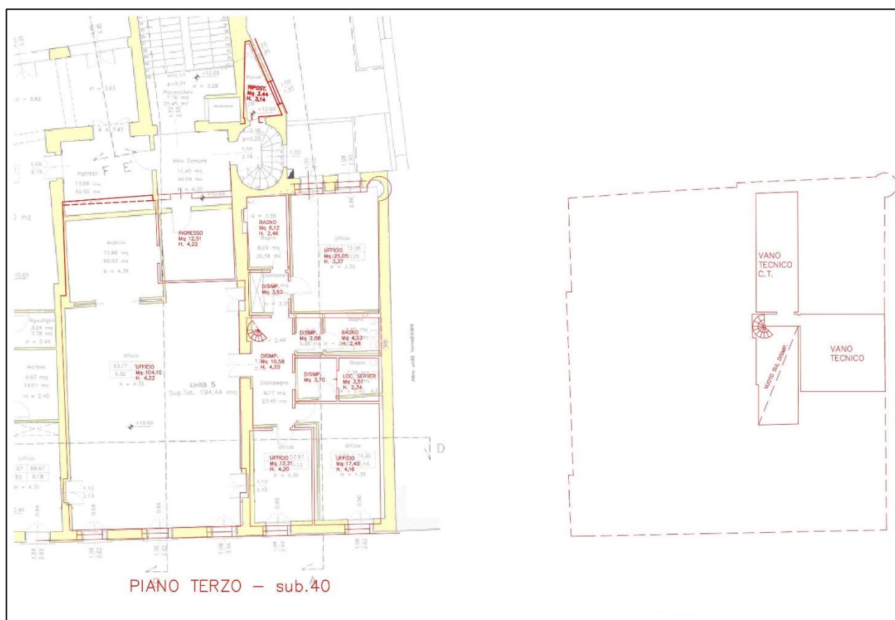
Sovrapposizione tra l'ultimo stato autorizzato e lo stato di fatto in rosso
