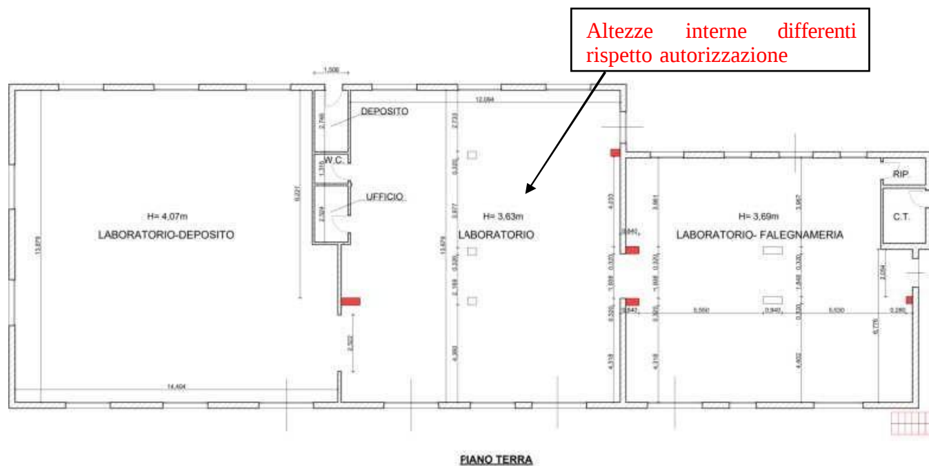
FIG. 10- SOVRAPPOSIZIONE STATO DI FATTO-PLANIMETRIA CATASTALE- PROGETTO APPROVATO- FOGLIO 19-SUB.5
