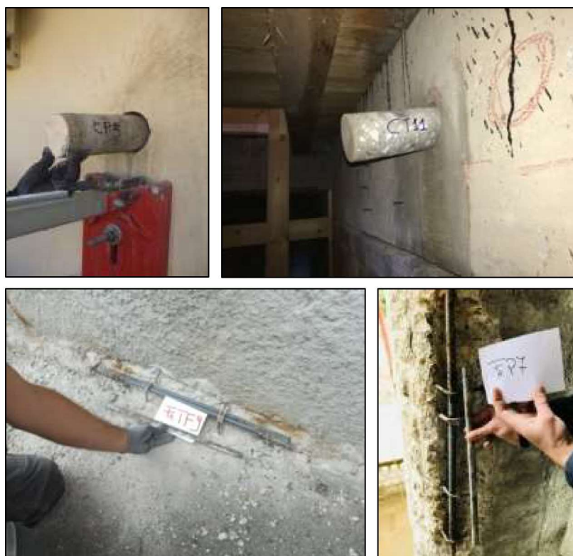
Figura 25 - Esempi di prelievi di carote di calcestruzzo e di barre di armatura
