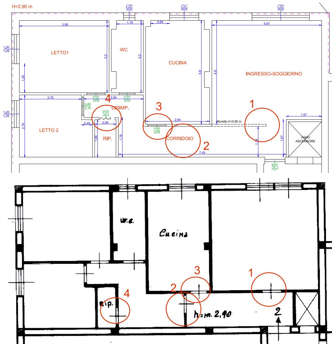
Figura 41 - Raffronto planimetria stato di fatto e planimetria catastale - BENE A - foglio 101, particella 163 subalterno 3
