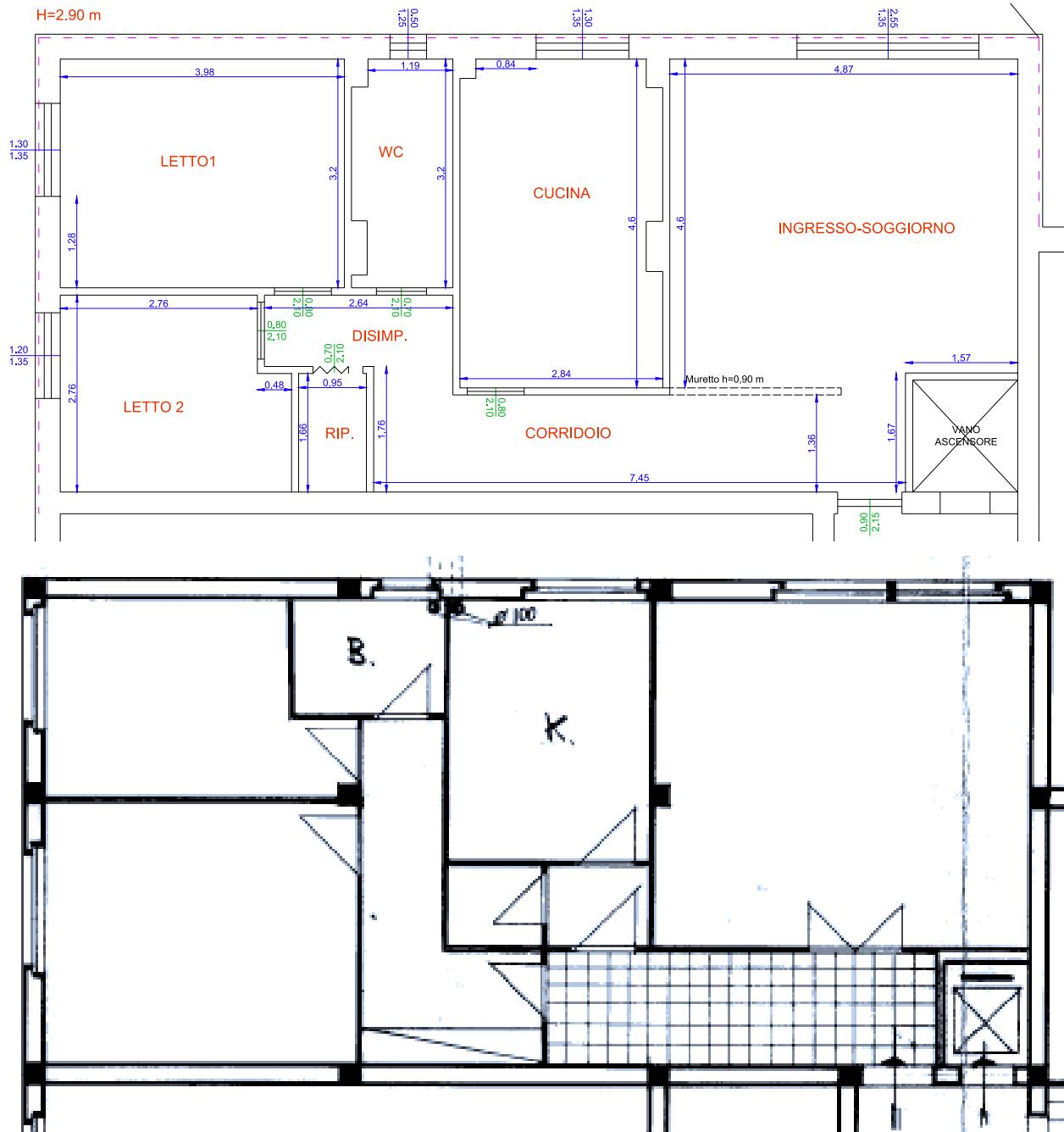
Figura 40 - Raffronto planimetria stato di fatto e planimetria progettuale - BENE A - foglio 101, particella 163 subalterno 3
