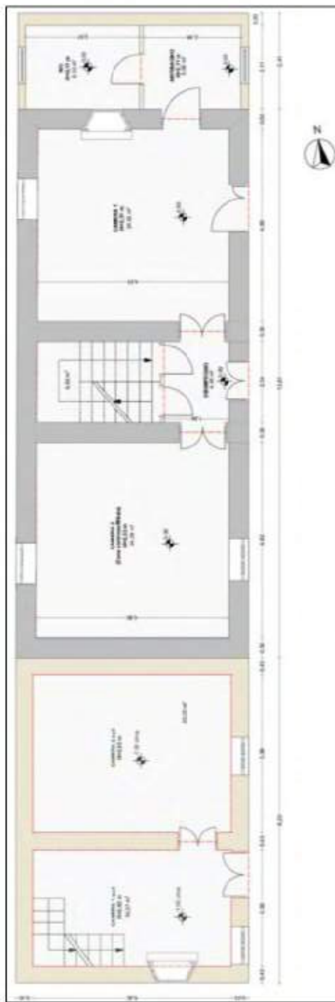
Figura 8: Rilievo metrico unità collabente foglio 11 particella 1397 sub 1 con indicazione delle superfici nette – piano terra.
