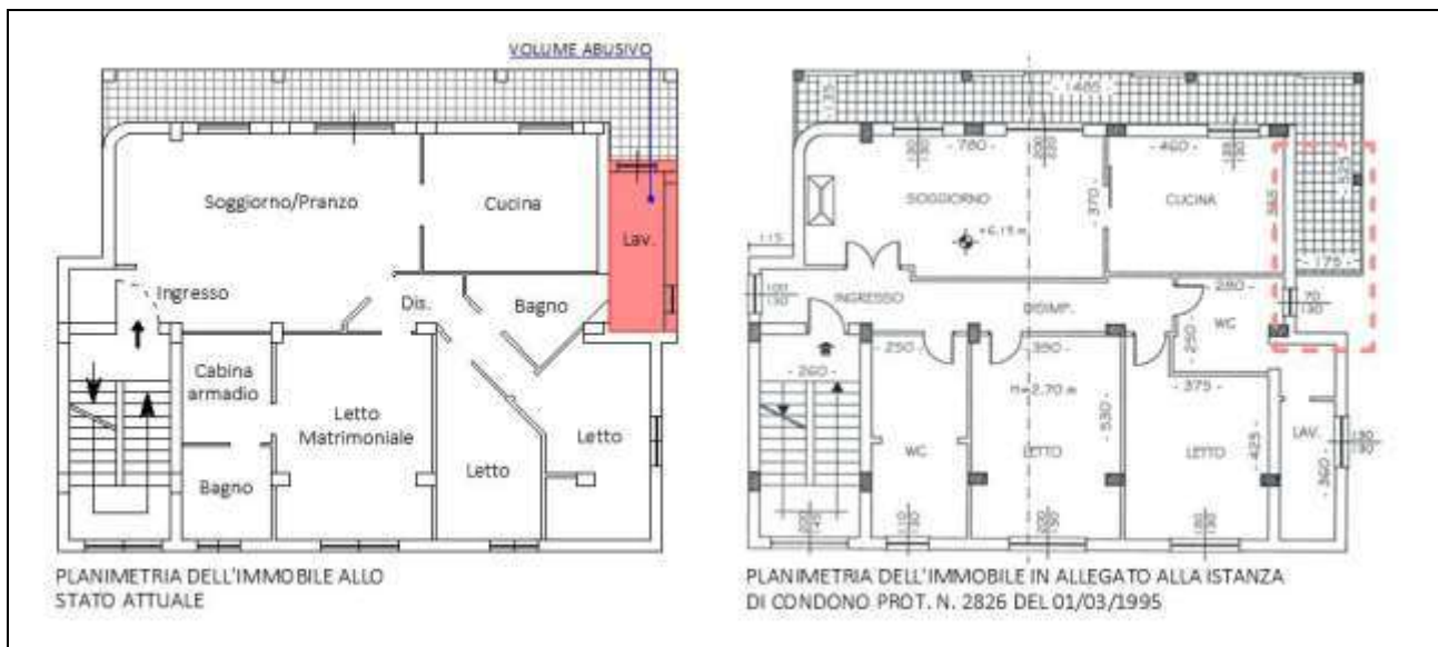
Fig. 12: Planimetria dell'immobile rispettivamente allo stato attuale ed allegate alla istanza di condono prot. n. 2826 del 01/03/1995.
