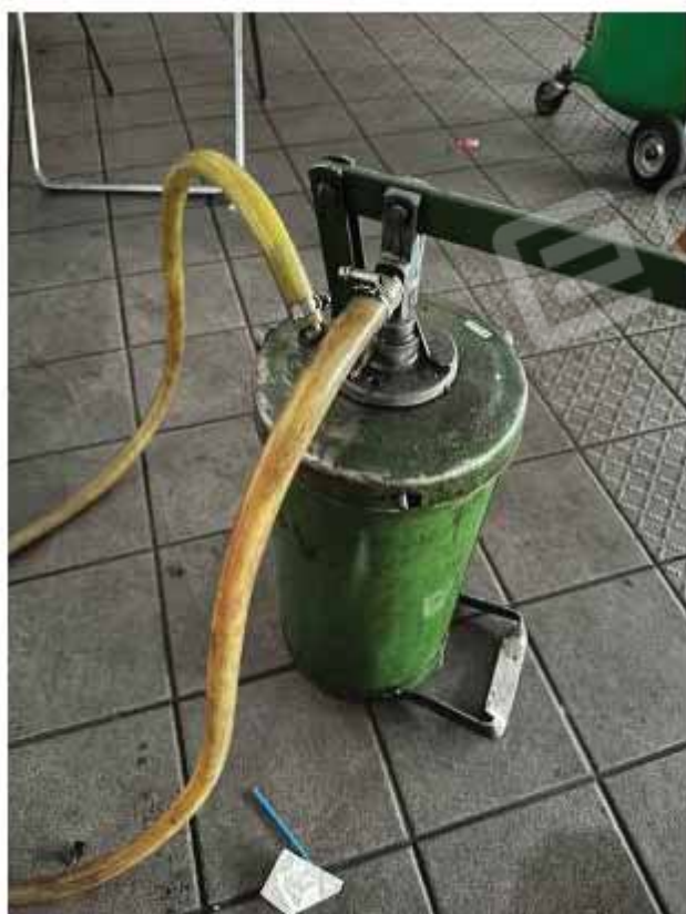
ID 0233 + 0234 Pompa travaso olio lubrificante LSD
