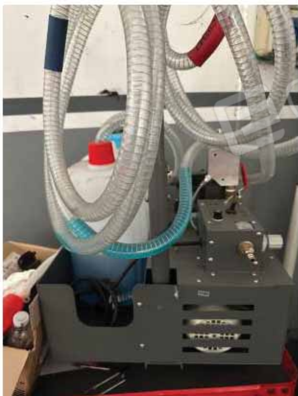
ID 0195 Banco lavaggio e sostituzione liquido refrigerante TOYOTA
