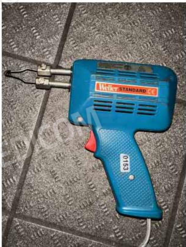
ID 0153 saldatore a pistola Weller standard 9200UC 100W 230V
