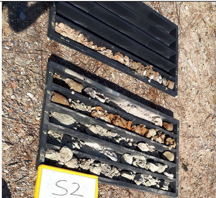
Cassette sondaggio S2 da 5 a 11 m
