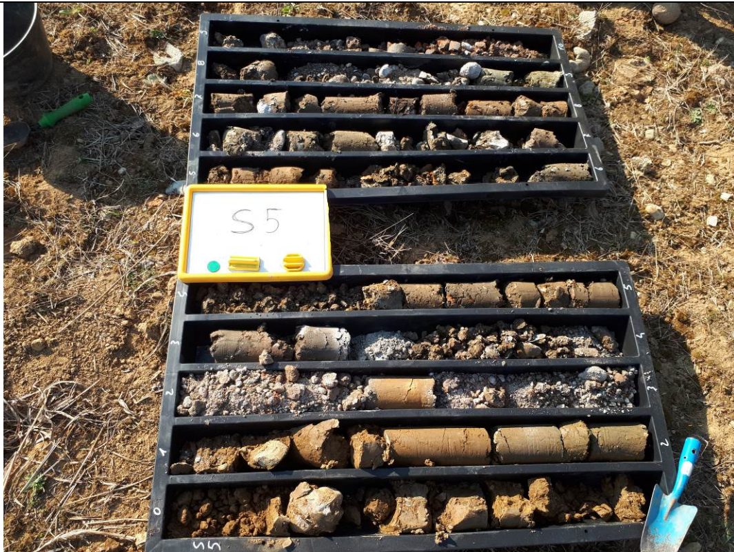
Cassette sondaggio S5 da 0 a 10 m
