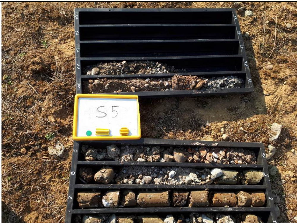
Cassette sondaggio S5 da 7 a 12,5 m
