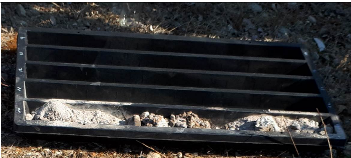
Cassetta sondaggio S4 da 10 a 11 m
