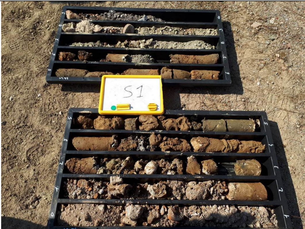
Cassette sondaggi S1 da 0 a 10 m
