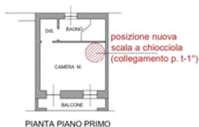
SOLUZIONE FINALE PROPOSTA CON DEMOLIZIONE/SANATORIA/ADEGUAMENTO
