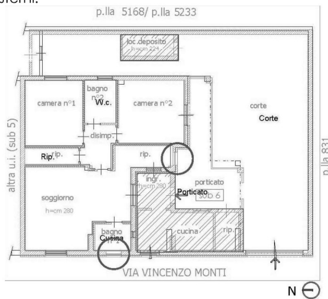
Sovrapposizione planimetria catastale u.i. SUB 6 e rilievo dello stato dei luoghi (in azzurro)
