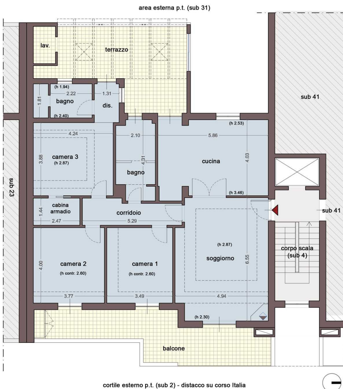
gr2.01: pianta stato di fatto APPARTAMENTO
